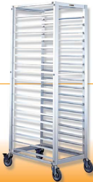
SN1990 层高:90mm 配套718X460、660X460烤盘 18层活动式铝合金台车(阳极) 723x526x1855
