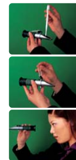
图1: 取1~2滴样本滴在棱镜上。
